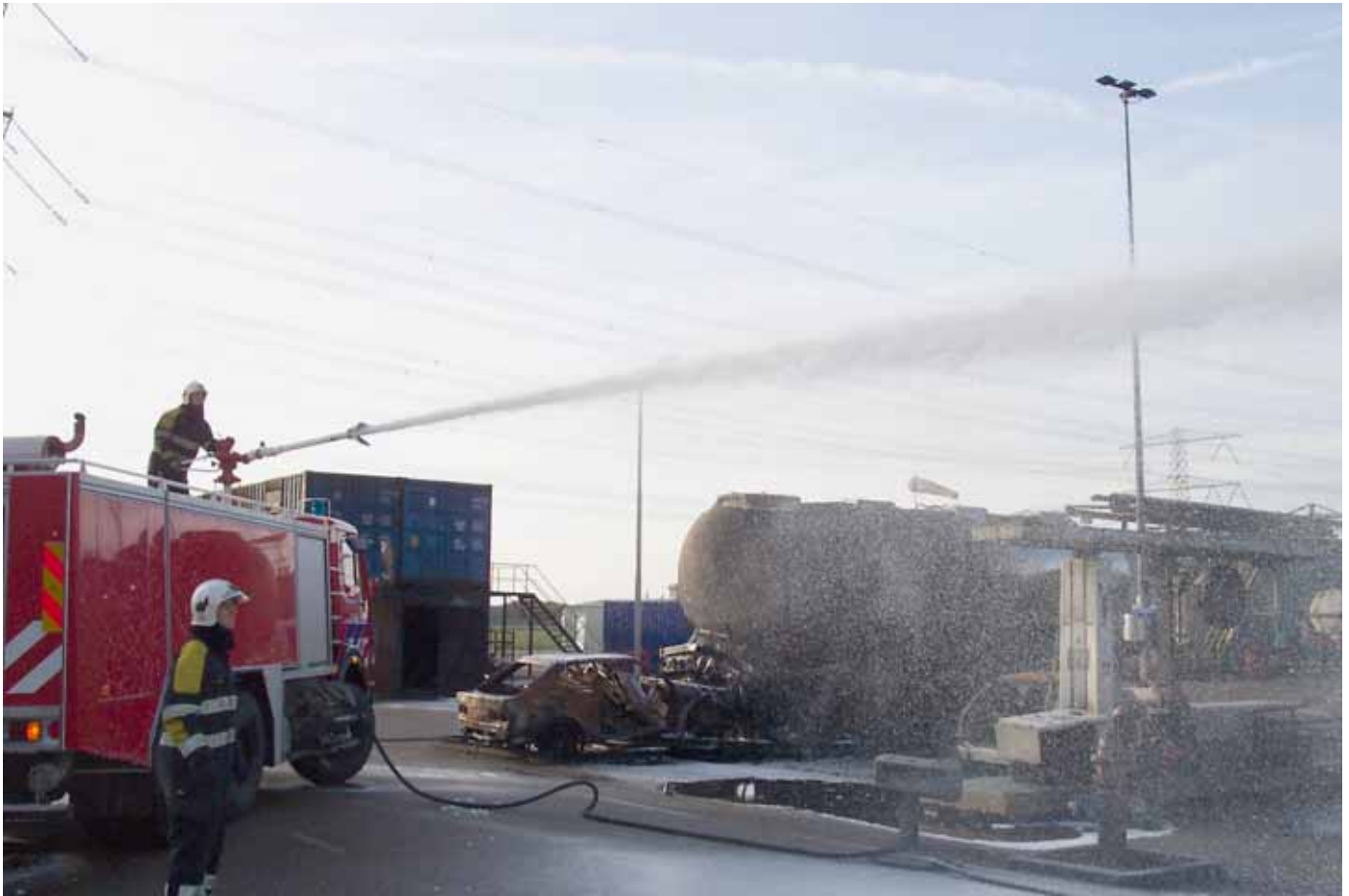
Löschschaumwerfer überbrücken die Zeit, bis Schlauchleitungen zur Brandstelle verlegt sind. (Bild: zvg)
